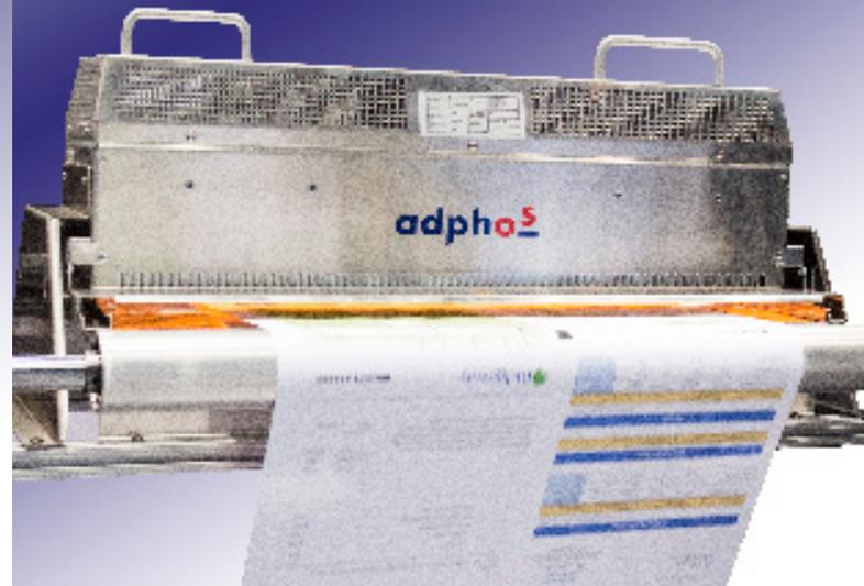
Der NIR126-550 ist die kompakte Lösung zum Trocknen/Erwärmen/Sintern für Bahn- oder Einzelblattanwendungen bis zu einer Breite von  $\leq 500$  mm (20") und bestens für Schwarzweiß- und Vollfarbanwendungen bis zu 150 m/min geeignet und das bei mehr Flexibilität, geringeren Anschaffungskosten und geringeren Betriebskosten im Vergleich zu anderen Lösungen
