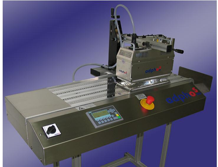
Das adphos NIR-MiniLab ist ein flexibles Trocknungs- und Vernetzungssystem für Versuch und Entwicklung oder Prototypenproduktion von gedruckter Elektronik oder anderen Druckanwendungen mit Tinten, die im Flexo-, Sieb-, Tief- oder Inkjetdruck aufgebracht werden.
